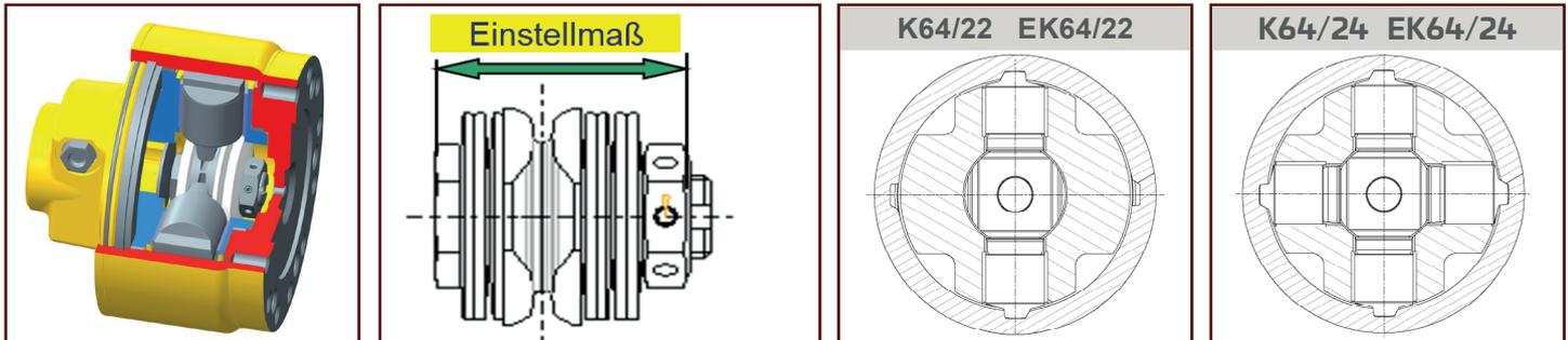
Alle Kupplungen werden von Walterscheid GmbH exakt auf das vorgegebene Drehmoment eingestellt. Entsprechend dem geforderten Drehmoment ist das Federpaket voreingestellt.
