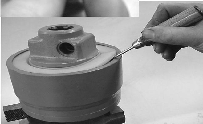
Dichtring mit Schraubenzieher an markierter Stelle anheben und herausnehmen.
