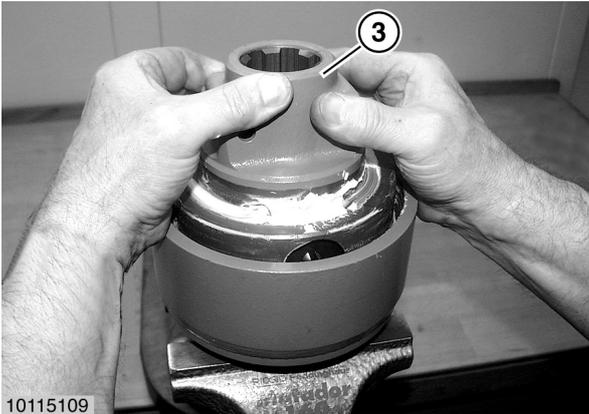
Komplett bestückte Nabe (3) ins Kupplungsgehäuse einsetzen.
