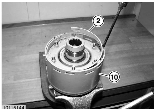
Einstellring (2) vorsichtig aus dem Kupplungsgehäuse (10) heraushebeln.
