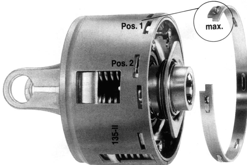
Das Drehmoment kann durch den Einstellring und durch zwei verschiedene Aufnahmepositionen im Kupplungsgehäuse verändert werden
