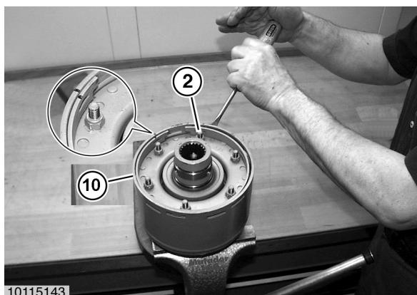
Montageposition des Einstellrings (2) zum Gehäuse (10) markieren.
