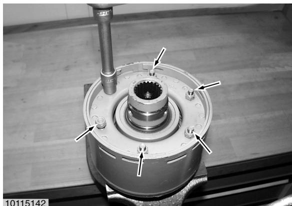
Einstellring (2) , durch abwechselndes Anziehen der sechs Muttern (Pfeile) am Federpaket (eine Umdrehung) entlasten.
