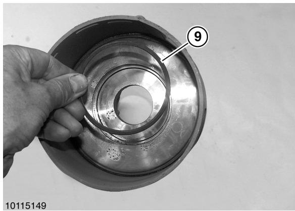
Bei Bedarf Laufring (9) aus dem Kupplungsgehäuse drücken.
