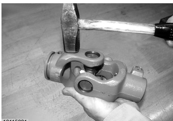
Gelenk durch Hammerschläge auf die Gabelschenkel
