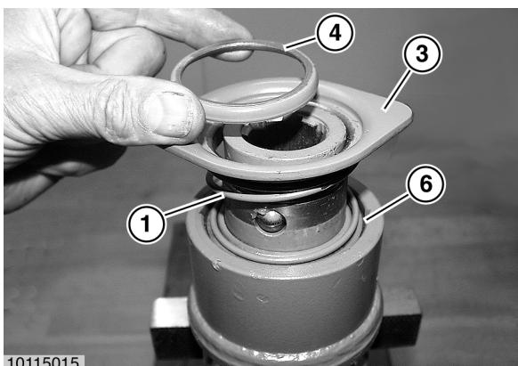
Bei verschiedenen Kupplungen Stützring (6) aufsetzen.
