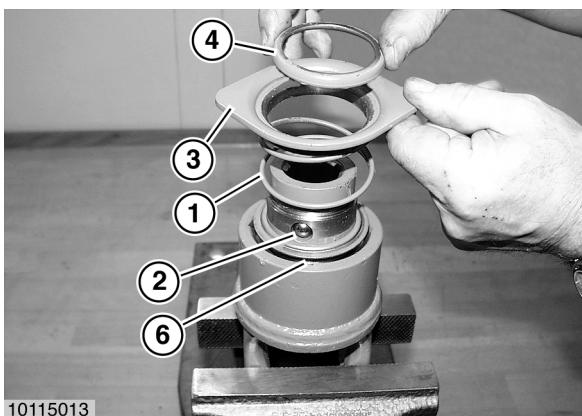
Winkelring (4), Sperrhülse (3), Druckfeder (1) und Kugeln (2) entfernen. (Bei verschiedenen Kupplungen noch den Stützring (6) abheben).
